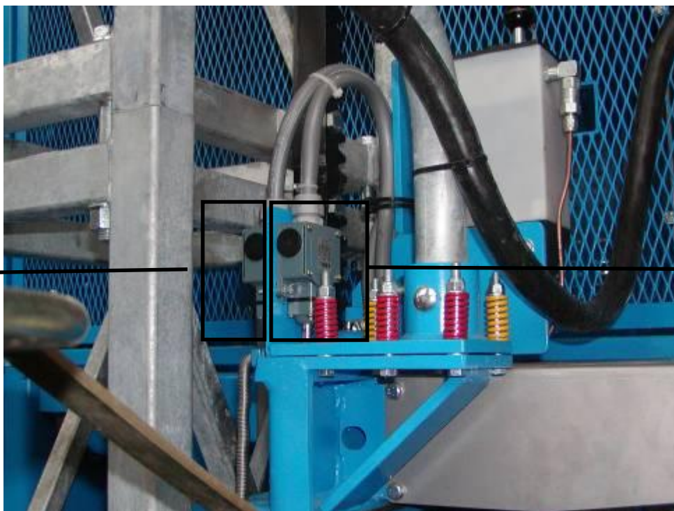
Afb. 10 – Eindschakelaar voor kabelgeleider en mastsensor
